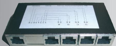
Modulkassette zur Verteilung von vier Stück 2-poligen Telefonanschlüssen. Eingangsbeschaltung erfolgt 4-paarig über den 1. RJ45 Port. Ausgangsbeschaltung zweipolig auf vier RJ45 Ports. Chassis und Deckel bestehen aus galvanisiertem Kunststoff. Der Verteiler eignet sich für die direkte AP- Montage und kann daneben mittels doppelseitigem Klebeband oder Klettband montiert werden.
