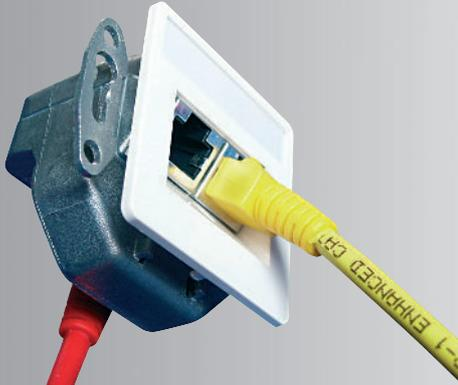
Die paarweise gegenüberliegenden RJ45 Ports der Patch-Patch Anschlussdose sind von Eingangs- zur Ausgangsseite 1:1 (Durchgang) beschaltet. Die Anschaltung der Dose im Ein- und Ausgang erfolgt über gesteckte RJ45 Verbindungen. Die RJ45 Buchsen auf der Vorderseite sind im 35° Winkel und auf der Rückseite im 90° Winkel angeordnet.
